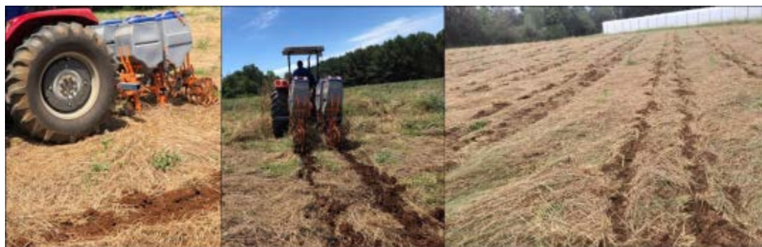
Figura 5 - Máquina tracionada por trator para corte da palhada e demarcação das linhas de plantio de tomate em plantio direto.
