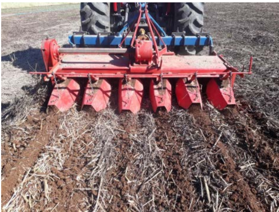
Figura 8 - Máquina (rotocar) para corte da palhada e abertura de sulcos para PD de cebola, mantendo inalterado o solo e a cobertura com resíduo vegetal na entre-linha.
