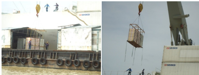
Figura 21: Pallets em grupos de três (E), e pallets suspensos pelo guindaste (D).
