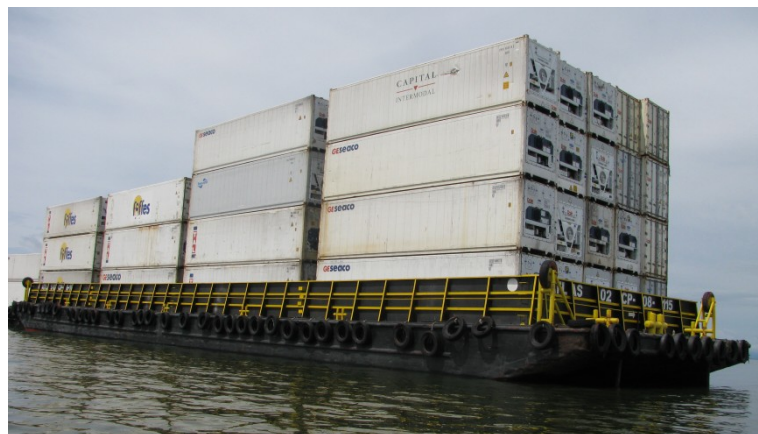
Figura 19: Balsa para transporte de containers vazios.
